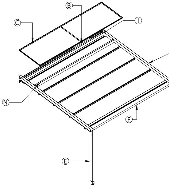
Struttura ombreggiante in alluminio con tenda richiudibile ad impacchettamento, formata da un telo (teso quando aperta) fissato ad un sistema di traversi, carrelli e guide che ne permettono lo scorrimento orizzontale. Resistenza al vento garantita fino alla classe 3 secondo la UNI EN 13561. Su richiesta è possibile installare il sistema antigoccia per la protezione dalla pioggia. Non si garantisce la tenuta al carico di neve.
